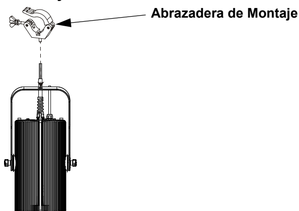
Montaje en Altura
